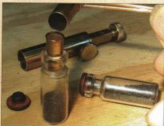
Les tubes sont chargés en atelier dans un environnement de sécurité. Correctement fabriquée et utilisée, la chargeur donne une précision satisfaisante.
