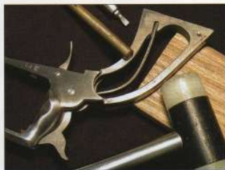
Déposer la vis et les plaquettes de crosse. Avec un jet en cuivre, frapper la base du grand ressort pour le faire échapper de sa fente-logement.
