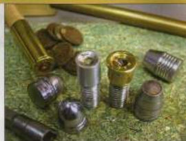
Un nouveau poussoir de balle plate est usiné dans un culot de 38 SP pour saisir et centrer correctement le nez plat d'une balle semi wad cutter.
