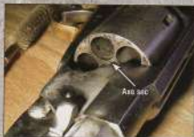
Au tir l'axe de barillet a tendance à sécher dans son logement. Il faut le graisser généreusement.
