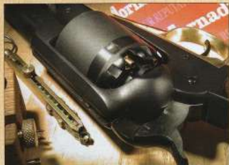
Les revolvers en 36 étaient souvent fabriqués sur les mêmes carcasses et présentent le même gabarit que les revolvers en 44.
