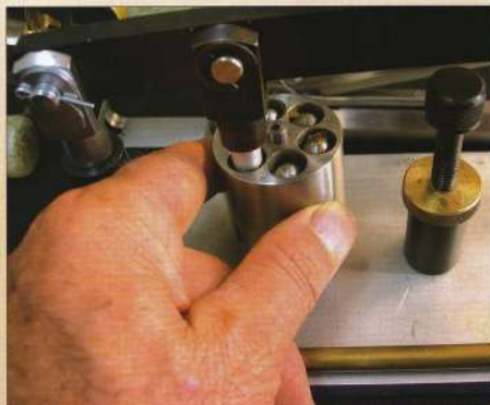
On obtient une poussée verticale en jouant sur la rotation manuelle du barillet et sur le pivotement du gând levier.
