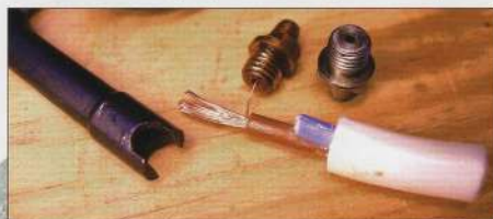
Les brins de câble électrique domestique mesurent 25/100. On s'en sert pour déboucher ou mesurer le diamètre de lumière.
