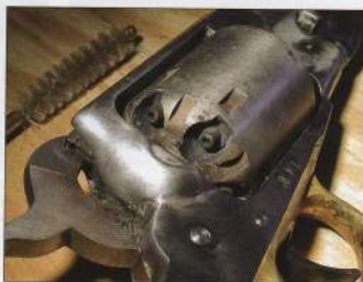
Les inévitables fuites de gaz laissent des traînées de suie et c'est le barillet qui est le plus délicat à nettoyer.
