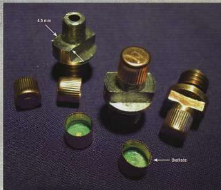
Nos cheminées de revolver mesurent 4,5 mm sur plats. On ovalise l'amorce en la pinçant si la tenue sur le cône de cheminée est insuffisante.
