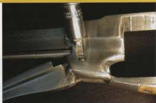
Dévisser la vis-axe de refouloir. Déposer le refouloir et finir d'extraire l'axe du barillet.
