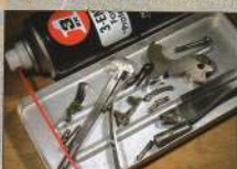
La double protection commence par une pulvérisation des pièces propres et sèches à la bombe anti-rouille.
