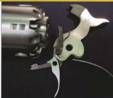
Sur le revolver comme sur le pistolet auto la platine simple action garde de nombreux fidèles. La platine Remington avait atteint la perfection il y a 150 ans déjà.
