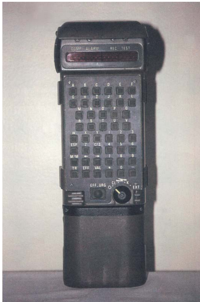
Fig. 16. – Le terminal tactique QR PM 1AM (TRC 743) « TERMIT »
