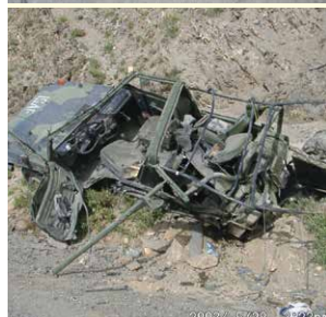
PHOTO 2.21 Impact d'une mine antipersonnel MRUD sur une voiture ; Balkans. Photo ONU
