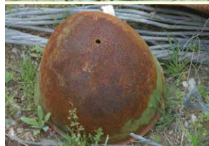
PHOTO 1.12 Cartouche Krupp de 77 x 229 mm, Essen/Allemagne 1906 - Fabriquée pour les forces turques ; Kosovo. Photo UNMAS/Thomas Enke
